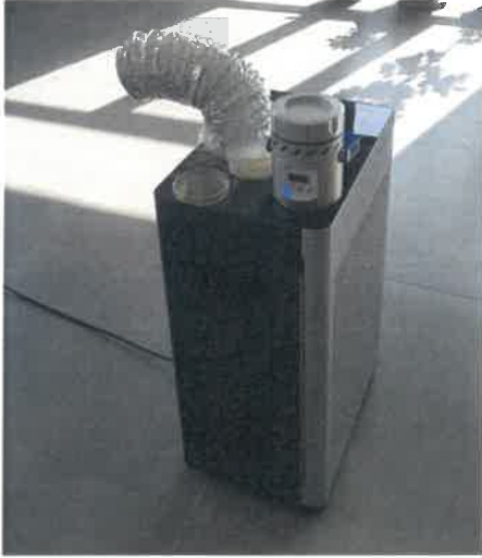
Şekil 2. Kapalı devre örnek alma düzeneği
